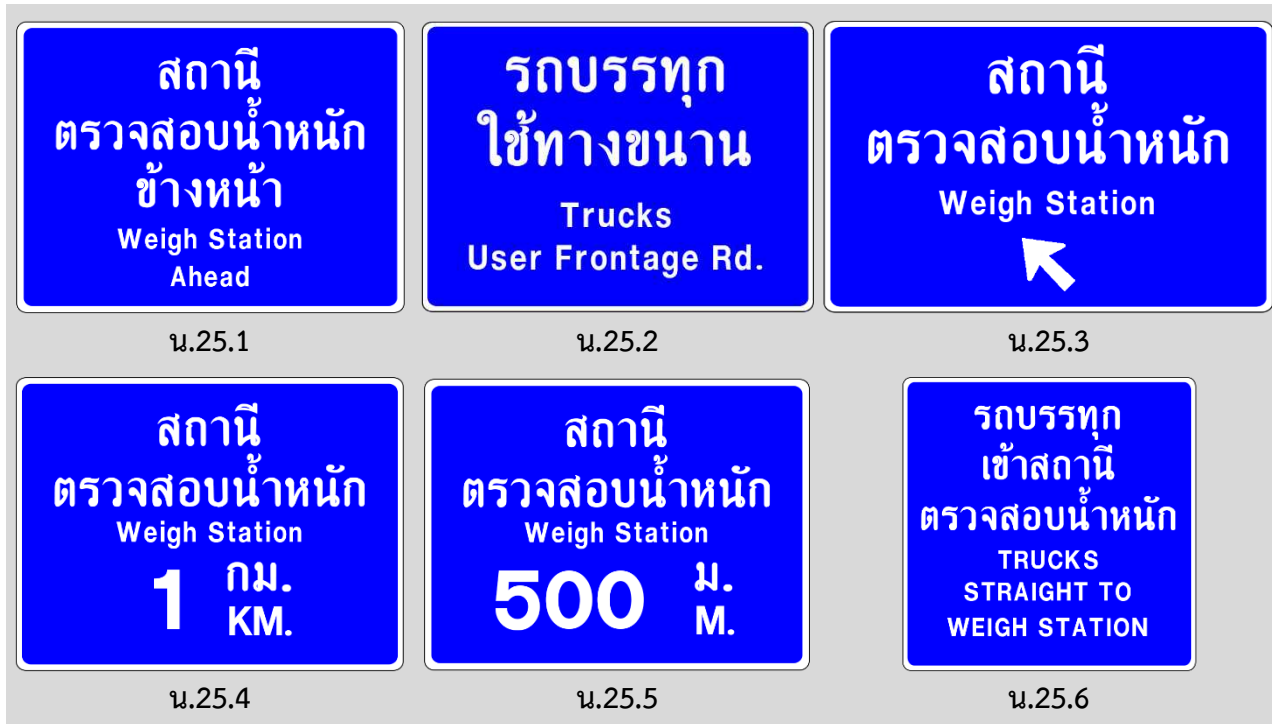
รูปที่ 7-1 ป้ายแสดงสถานีตรวจสอบน้ำหนัก (น.25.1-น.25.6)
